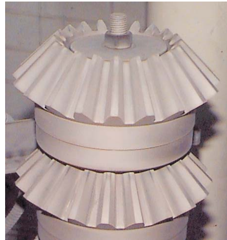
Partielles Nitrieren von Zahnrädern
